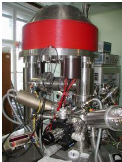
Az anyagtudományokat szolgáló ESA-31 elektron spektrométer
