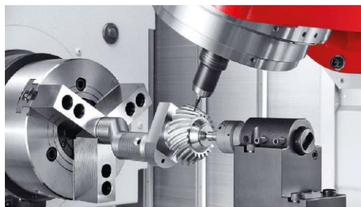
6. ábra. Ferde fogazatú hengeres fogaskerék előállítás 'millturn' technológiával [18]
