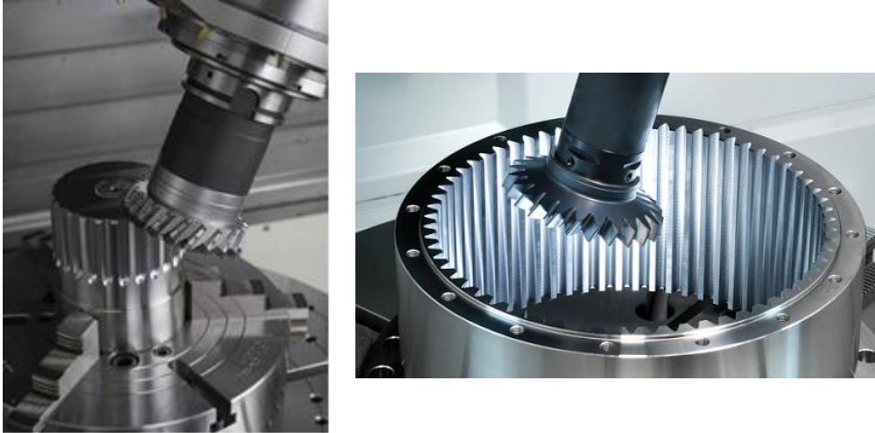
8. ábra. Külső és belső fogazat megmunkálása forgó szerszámossal lefejtéssel CNC szerszámgépen
