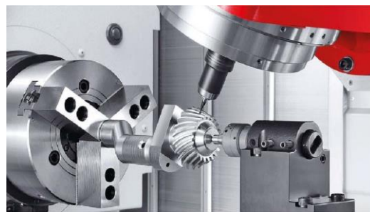
6. ábra. Ferde fogazatú hengeres fogaskerék előállítása 'millturn' technológiával [18]
